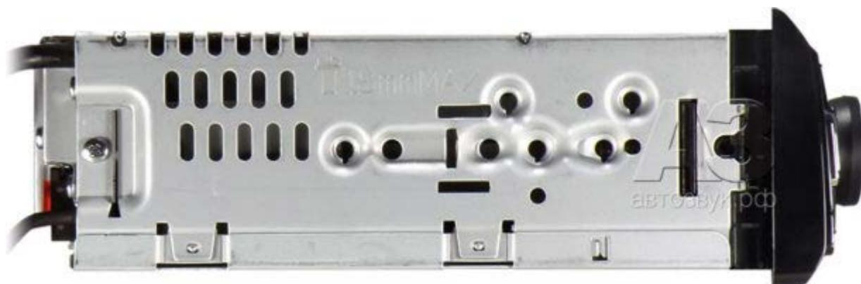
Дисковый транспорт определяет глубину корпуса – она стандартная
