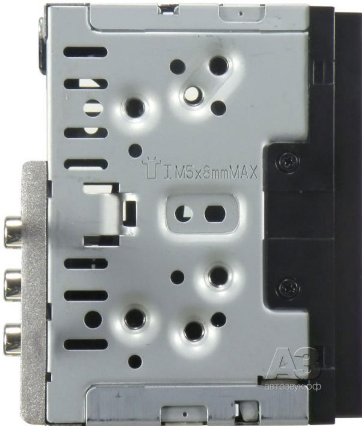
Дискового привода нет, в результате удалось уменьшить глубину аппарата до рекордных 75 мм, это позволяет устанавливать его даже в автомобили с «проблемными» посадочными местами. К тому же увеличение свободного пространства с тыльной стороны корпуса положительно сказывается на охлаждении, устройство работает в более стабильном температурном режиме. Внутри, как можно заметить, довольно просторно
