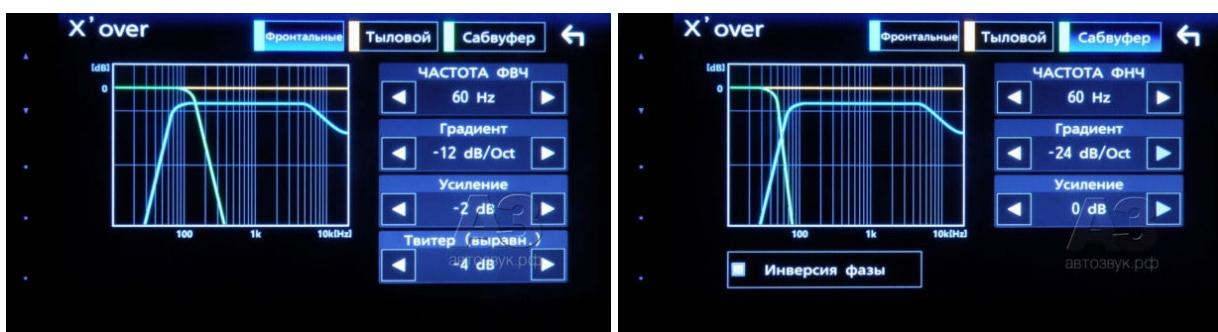
В настройках кроссовера задаётся частота среза и крутизна фильтров, уровень сигнала на выходе канала. В канале сабвуфера предусмотрена инверсия сигнала, а во фронтальных – «полочная» коррекция твиттера
